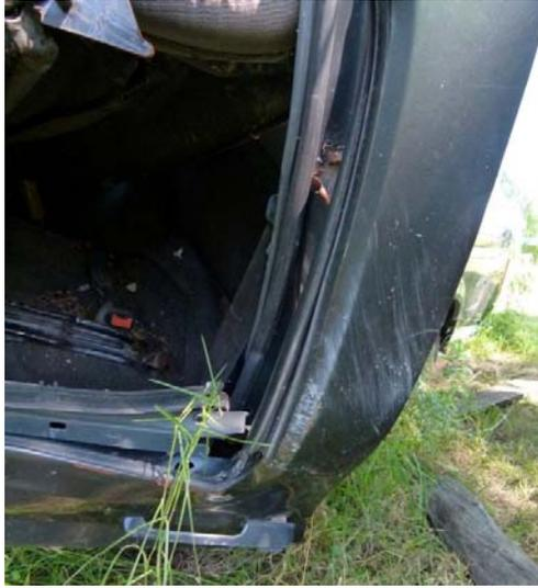
Sabemos entonces que entre ambos vehículos tuvo que producirse un contacto de tipo rasante – primera colisión-, que para la camioneta F100 debió comenzar a la altura de la puerta delantera, donde ya se observan rastros de pintura blanca. Y continuó hasta la parte trasera de la misma, ya que en su portón trasero se puede observar el plegado de la chapa hacia atrás.
